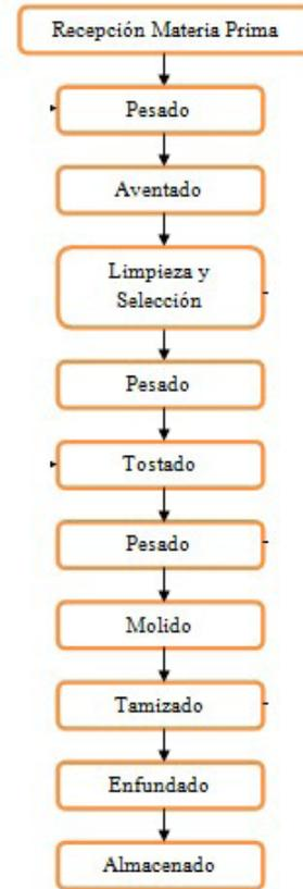
Figura 1. Diagrama de bloques del proceso
