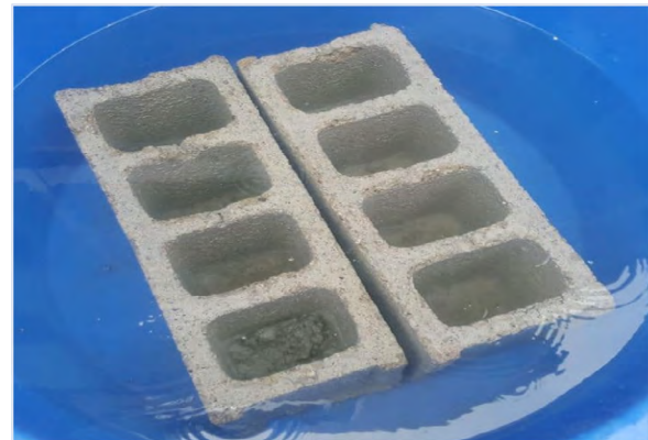
Figura 3. Muestras de bloques sumergidas en agua, para el cálculo de la densidad y porcentaje de absorción.
